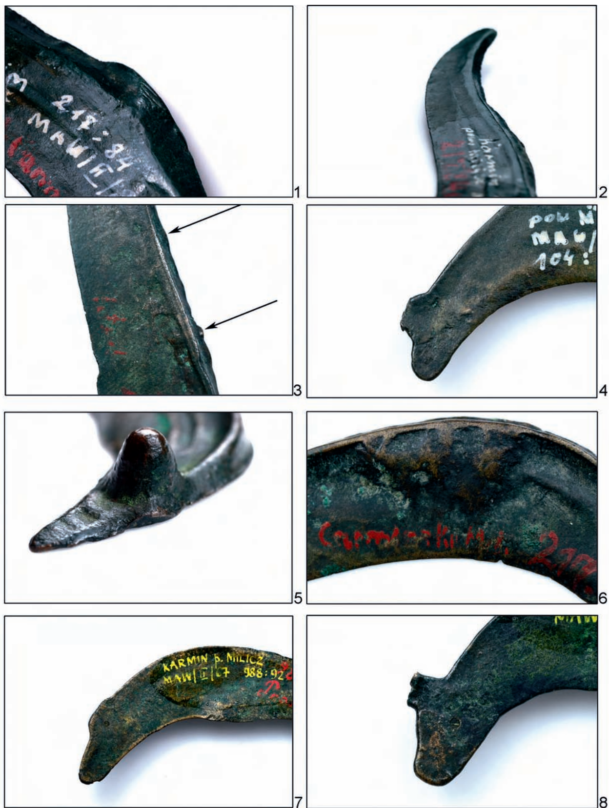
Ryc. 23. Ślady produkcji na przedmiotach metalowych: 1 – ślady usuwania kanału wlewowego (nr 23); 2 – ślady kucia ostrza (nr 23); 3 – szwy odlewnicze na grzbiecie sierpa nr 24; 4 – równa linia cięcia przy krawędzi kanału wlewowego (nr 27); 5 – równa linia cięcia kanału wlewowego ze śladami po usuwaniu (nr 29); 6 – nadlew metalu poniżej kanału wlewowego (nr 25); 7 – równo ucięty kanał wlewowy (nr 67); 8 – kanał usunięty niestarannie z nierówną krawędzią (nr 75). Fot. i opr. K. Nowak
