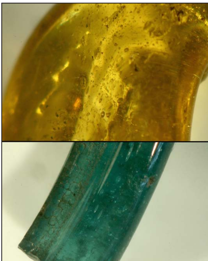
Ryc. 1. Pęcherzyki gazowe i kapilary widoczne w korpusach przedmiotów, układające się równolegle w stosunku do bocznych ścianek
