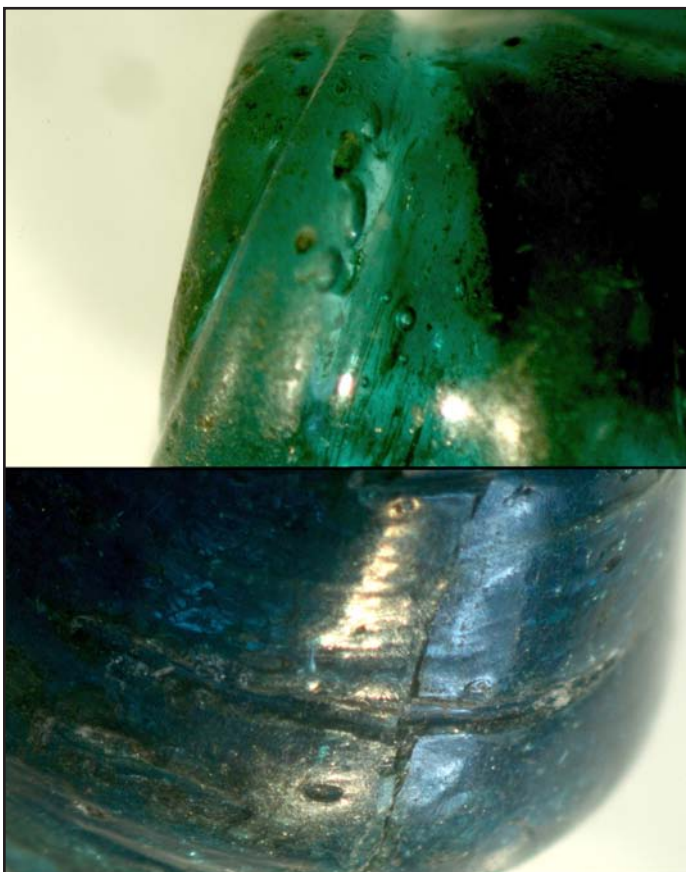
Ryc. 2. Ślady zlepiania nitek oraz pęcherzyki gazowe widoczne w szkle
