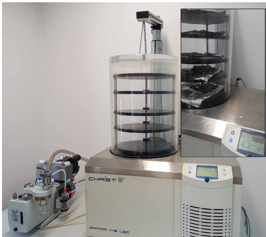
Ryc. 11. Liofilizator pracujący przy odwadnianiu zabytków wykonanych z surowców organicznych, widoczny przebieg przykładowego suszenia średniowiecznego drewna z Wrocławia. Fot. B. Miazga
